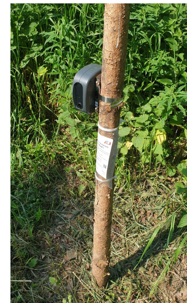
Zählgeräte (Typ Pyro Evo M, Eco Counter) zur Erfassung der Besucherintensität am Schlacker in Freiburg im Breisgau (© Wir im Wald, Juni 2023)
